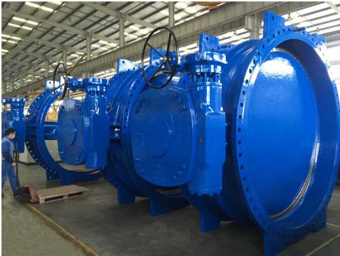
Червячный редуктор QS600 с моментом 600 000нм смонтированный на затворе DN 4000 мм
